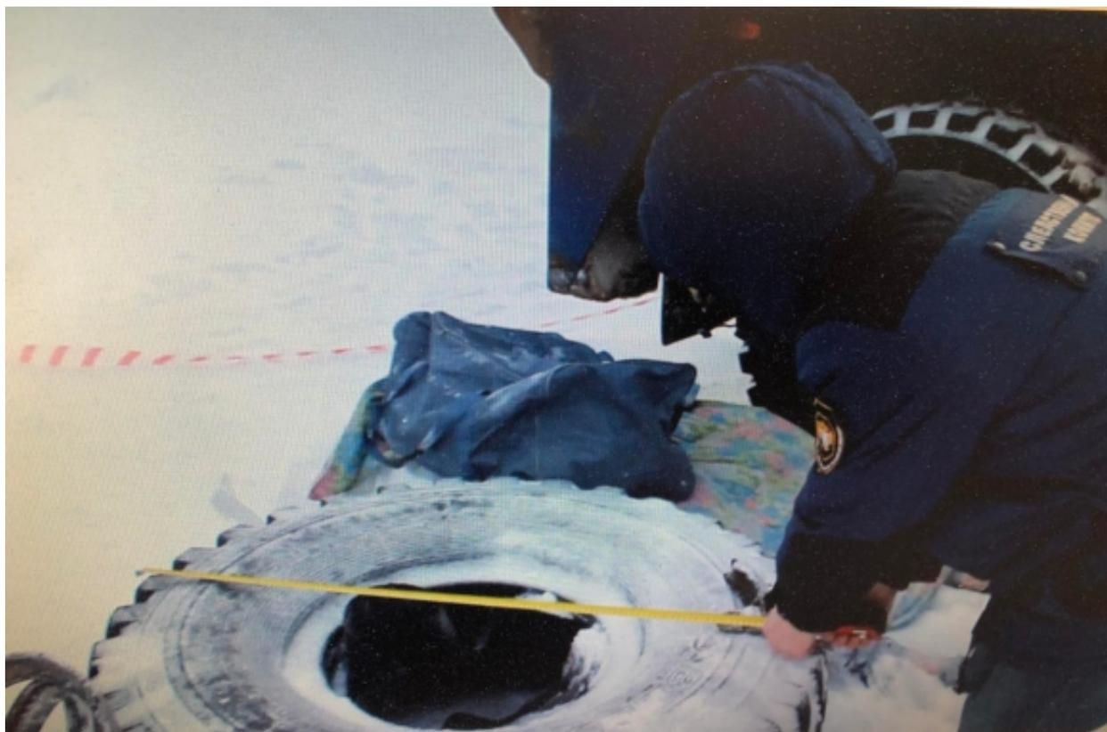
23 декабря 2021 года в 12 часов на одном из месторождений Уватского района Тюменской области во время снятия 43 – летним машинистом паровой передвижной установки колеса автомашины КАМАЗ, произошло разрушение металлического колесного диска. В результате произошедшего инцидента шина с поврежденной камерой слетела с места крепления и смертельно травмировала мужчину.
